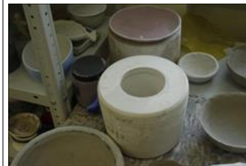
Керамическая форма Форма, использованная для изготовления сувенирной продукции (кружки) в керамической мастерской.
